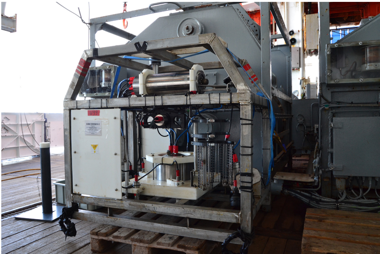
Abb. 1.2: Das OFOS – Ocean Floor Observation System (AWI, Quelle: M. Molari) ist mit einer HD Photo- und Videokamera, einem Posidonia-Transponder sowie verschiedenen physikochemischen Sensoren bestückt.
