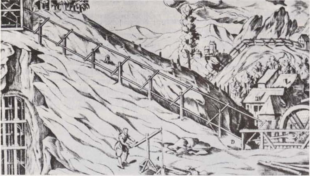
**Bild 6: Das Feldgestänge überträgt die Kraft vom Wasserrad auf eine Pumpenkunst**
