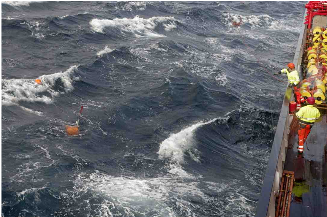
Das Bergen der OBS bei stürmischer See ist eine Herausforderung für die Besatzung auf der Brücke und auf dem Arbeitsdeck. In diesem Fall wurde mit dem Enterhaken die Schwimmleine des Geräts mit nur einem Wurf erwischt (Foto: T.N. Gades).
