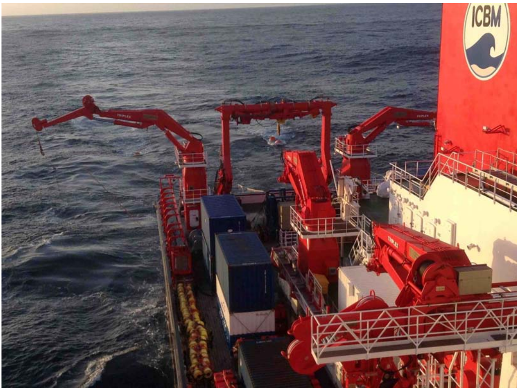
Fünf Geräte gleichzeitig werden von der SONNE geschleppt. Von links nach rechts: Passives Akustisches Monitoring-System (PAM), Luftpulser-Strang Steuerbord, seismischer Hydrophon-Streamer, Luftpulser-Strang Backbord, Magnetometer. Dank des breiten Hecks ist dieses problemlos möglich, ohne dass sich die langen Kabel verheddern.
