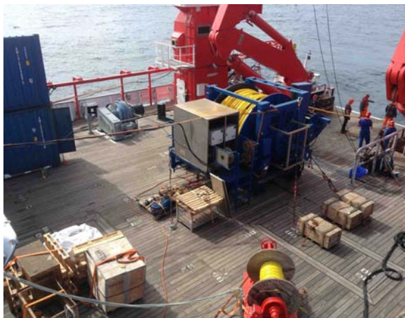
Viel Platz auf dem Arbeitsdeck für die große Seismikwinde mit dem 3000 m langen Streamer, der gerade eingeholt wird, Magnetometerwinde (unten) und Werkstatt-Container (Foto: K. Gohl).
