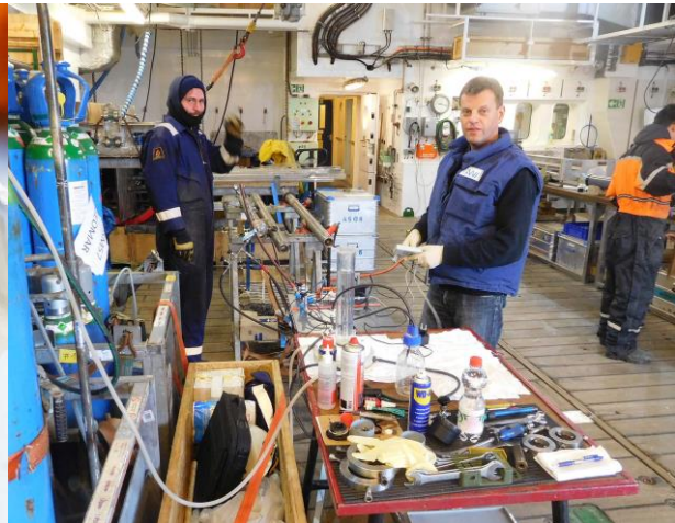
Abbildung 2: Der Autoklavprobennehmer (MDP) hat eine Probe im Bohrloch in 62 m Sedimenttiefe unter Formationsdruck eingeschlossen und wird nach erfolgreiche Einsatz im Labor quantitativ entgast.
