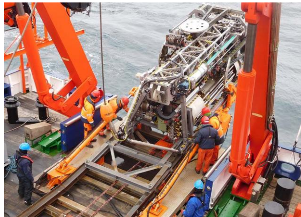
Abbildung 3: Nach Bergung durch die Decksmannschaft gleitet das MeBo auf einem Schienensystem auf seine Position an Deck zur Entladung der Bohrkerne.
