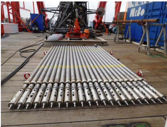
Abbildung 2: Innenkernrohre des Meeresbodenbohrgerätes MARUM-MeBo70 an Deck der MARIA S. MERIAN; bereit für die nächste Magazinbeladung.
