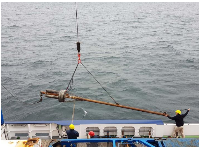
Abbildung 4: Die GEOMAR Temperatur-Lanze, die wir zur Messung des geothermischen Gradienten auf dem Vestnesa Rücken sehr häufig eingesetzt haben.
