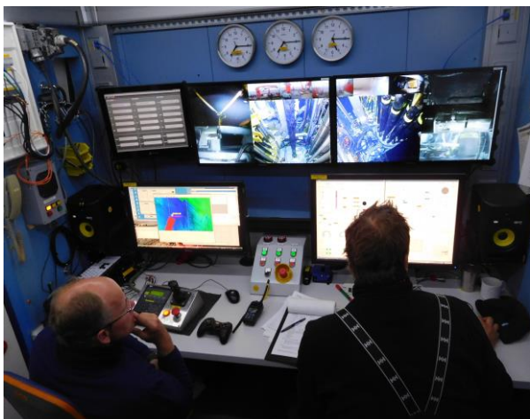
Abbildung 3: Im MeBo-Steuercontainer wird der Bohrvorgang am Meeresboden per Videoübertragung kontrolliert und gesteuert.
