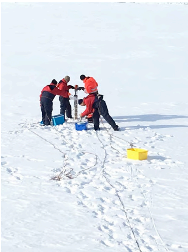
Beprobung auf dem Eis der Bottnischen Wiek: Ein Team von Ozeanographen und Geologen aus Warnemünde auf dem festen Eis beim Bohren von bis zu 40 cm mächtigen Eiskernen und CTD Messungen bis 100 m Wassertiefe durch die Bohrlöcher (Foto R. Schneider).
