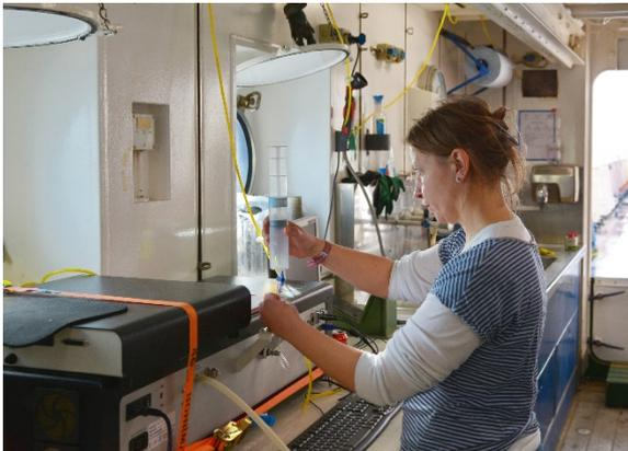
**Abbildung 1:** im Geolabor der METEOR misst Dr. Susan Mau mit dem Laser-basierten ICOS-Meßgerät die Treibhausgase CO<sub>2</sub> und CH<sub>4</sub> in Luft und Wasser (© A. Popa).
