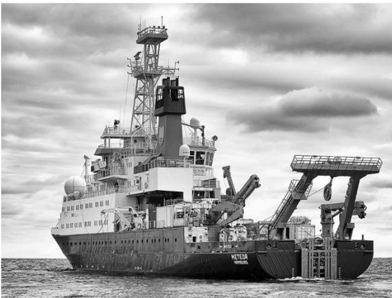
**Abbildung 3:** Wenn das Meeresbodenbohrgerät im Einsatz ist, verbleibt das Schiff für 2-4 Tage an gleicher Stelle. Nur das Kabel, welches über den A-Rahmen ins Wasser reicht und das Launchingsystem am Heck verraten den MeBo-Einsatz (© M. Beims).
