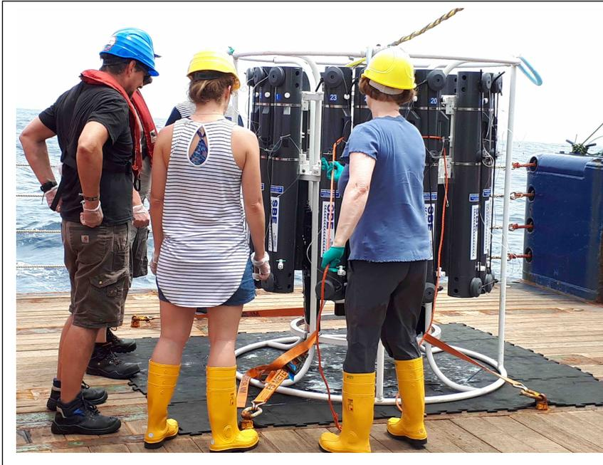
Die Spurenmetall-Rosette ist nach einem Einsatz in tieferem Wasser zurück an Deck und die Flaschen werden zur Beprobung abgenommen und in den Reinraum-Container gebracht.
