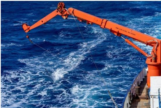
Auf dem Weg nach Süden wurde der Schleppfisch erstmals eingesetzt um Oberflächenwasser für ein Experiment mit gelöstem organischen Material (DOM) kontaminationsfrei direkt in den Reinraum-Laborcontainer zu pumpen, wo die Partikel dann direkt heraus gefiltert werden um nur mit den gelösten Stoffen arbeiten zu können.
