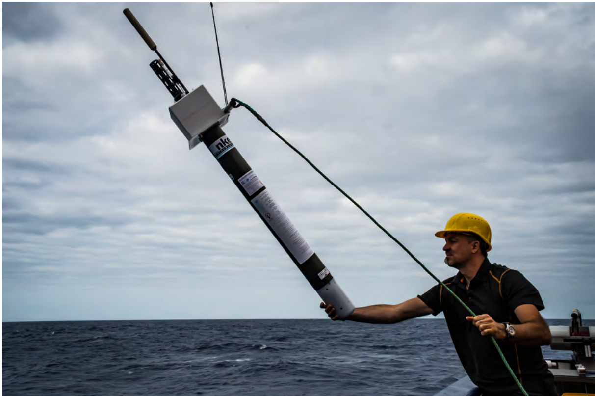
Abb. 1: Auslegen eines Argo Tiefendrifters (Foto: SvN).
