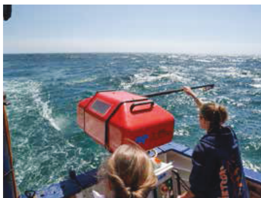
Die RapidCast Winde am Heck der METEOR spult die Leine der U-CTD Sonde ein.
