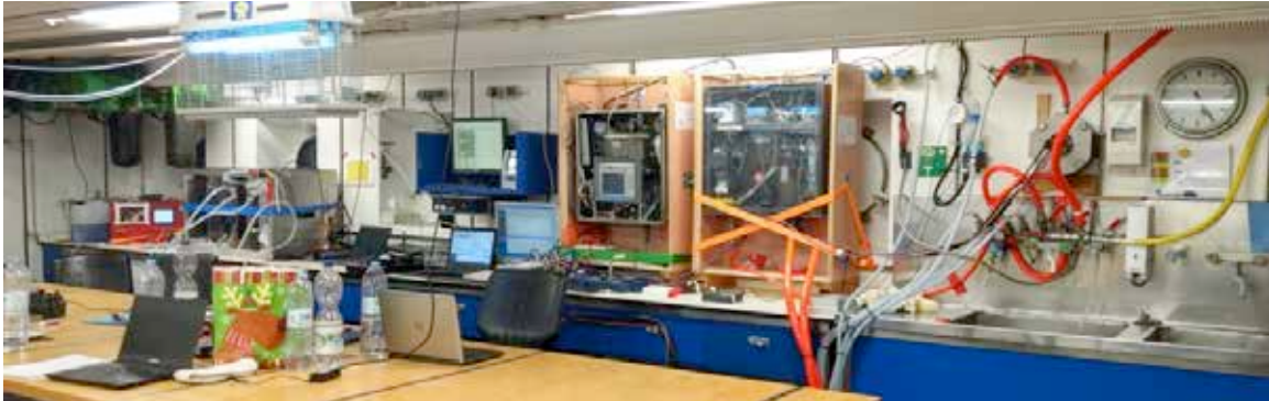
Anlagen zur kontinuierlichen Unterwegsmessung von chemischen Parametern wie Kohlenstoffdioxid, Sauerstoff und Methan. Photo: Tobias Hahn
