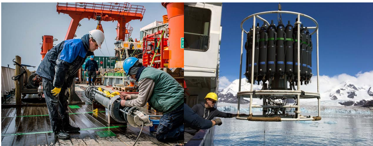
Abbildung 1: Das Autoklav-Kolbenlot DAPC wird nach Einsatz im Church Trog an Deck der METEOR auf seine Dichtigkeit hin untersucht.
