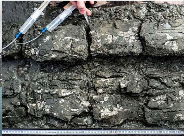
Abbildung 4: Ausschnitt eines gerade geöffneten Schwerelotes mit weißen Methanhydraten, die an Bord in Wasser und Methan zerfallen. Spritzenproben aus dem Sediment werden zur Untersuchung des Porenwassers genommen (© vdL).
