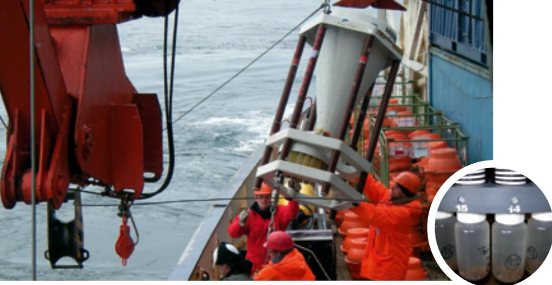
Bergen einer Sinkstofffalle. Mehrere Sammelflaschen sind am unteren Ende des großen Trichters (Durchmesser von 0,5m<sup>2</sup>) angebracht. Durch eine Mechanik in programmierbaren Zeitintervallen werden sie unter den Trichter gefahren und sammeln absinkende Partikel. Sinkstofffallen können über lange Zeiträume von mehreren Monaten oder Jahren ausgebracht werden. Fotos: E. Bauerfeind, A. Kraft, AWI
