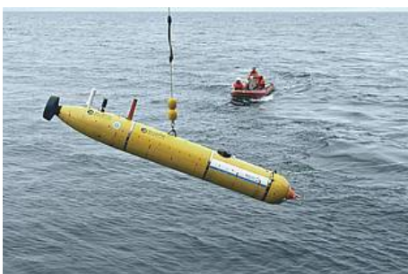
Abb. 2: Einsatz des Autonomen Unterwasserfahrzeugs "Paul". (Foto: J. Rapp)
