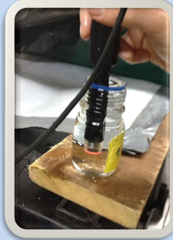
Figura 4: Medición de oxígeno contenido en una botella de agua incubada después de 12 horas con un dispositivo portátil
