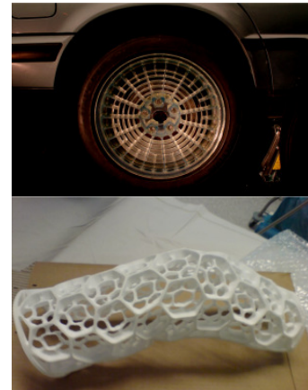
Abb. 3: Prototyp einer Autofelge (oben) und eines Gipsverbands (unten), die auf Grundlage abstrahierter Diatomeenstrukturen entwickelt worden sind. [C. Hamm, unpubliziert]
