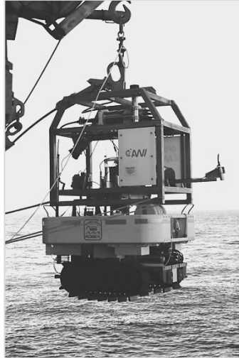
Abb. 6 a, b: Ausbringung der Meeresboden-Kettenfahrzeuge TRAMPER (oben) und NOMAD (unten) mit Hilfe eines Aussetz-Systems.
