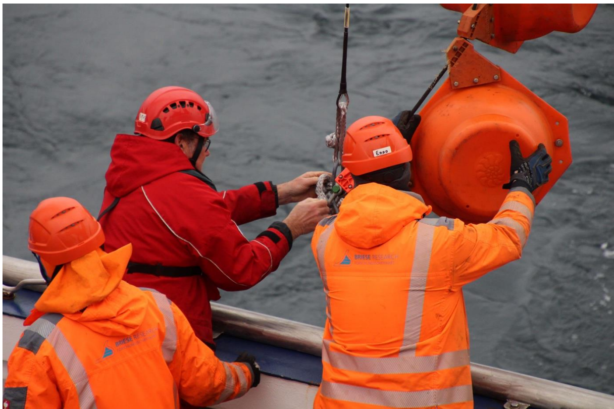
Abb. 2: Auslegung einer Verankerung im Westspitzbergenstrom über das Heck von Merian (Foto: Dragonfly Leathrum-Simons).
