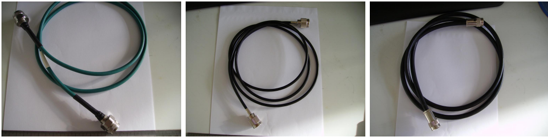
Abbildung 5.12: die drei Kabeltypen. Links und Mitte RG58 Kabel, rechts das RG213 Kabel
