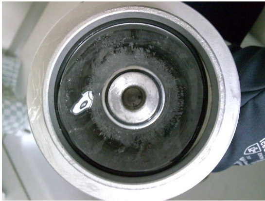
Abbildung 3.8: mit Eis gefüllte Koax-Zelle
