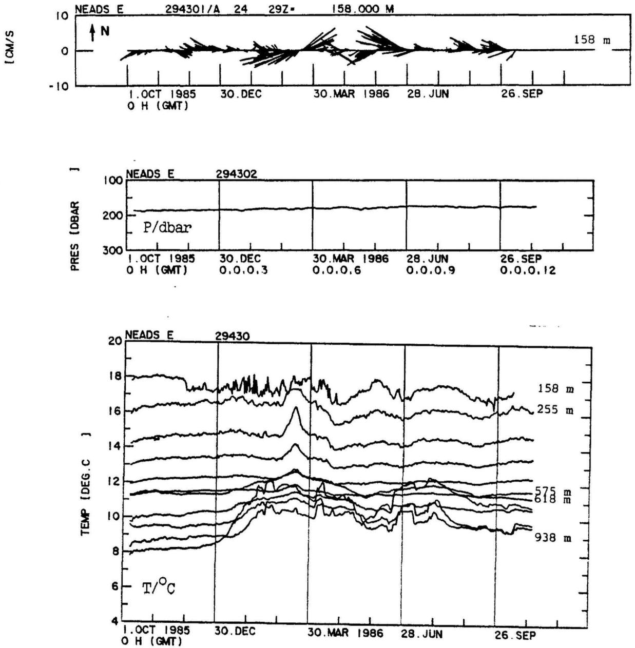
Abb. 3.13: Verankerung E/294-3. Zeitreihen des Strömungsvektors in 158 m Tiefe sowie von Druck und Temperatur in der Hauptsprungschicht
