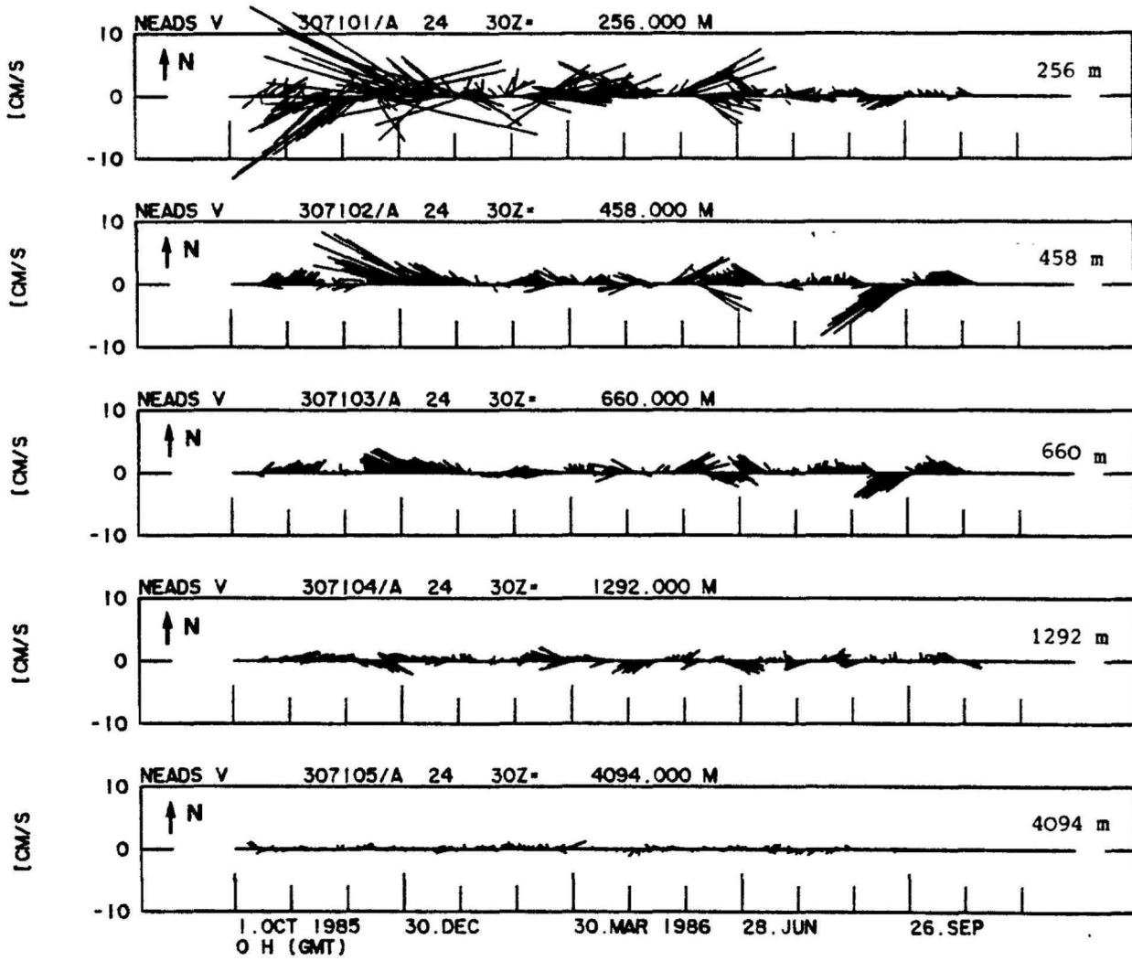
Abb. 3.15a: Verankerung V/307-1; Zeitreihen des Strömungsvektors in 5 Tiefen
