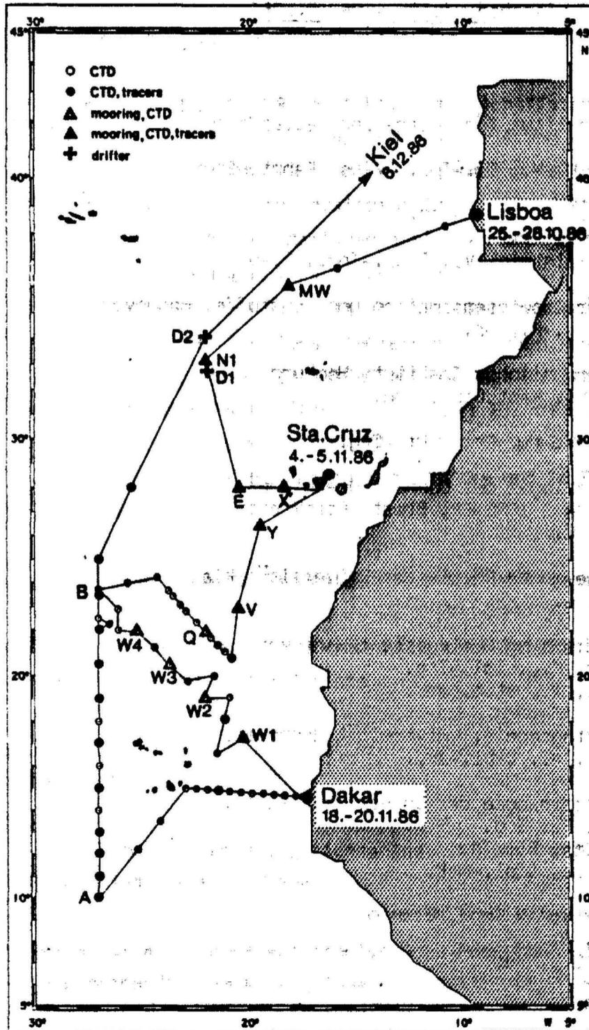
Abb. 1.2: Fahrtroute während MA/2, MA/3 und MA/4 mit Positionen für CTD-Stationen und Verankerungsarbeiten. Von Position Y bis Dakar wurden XBT-Messungen, von Dakar bis Position D2 XBT- und GEK-Messungen durchgeführt
