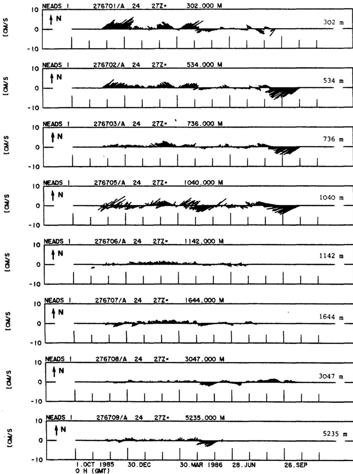
Abb. 3.11a: Verankerung N1/276-7; Zeitreihen der Strömungsvektoren in 8 Tiefen. Die Zeitachse verläuft parallel zur W-O-Richtung.
