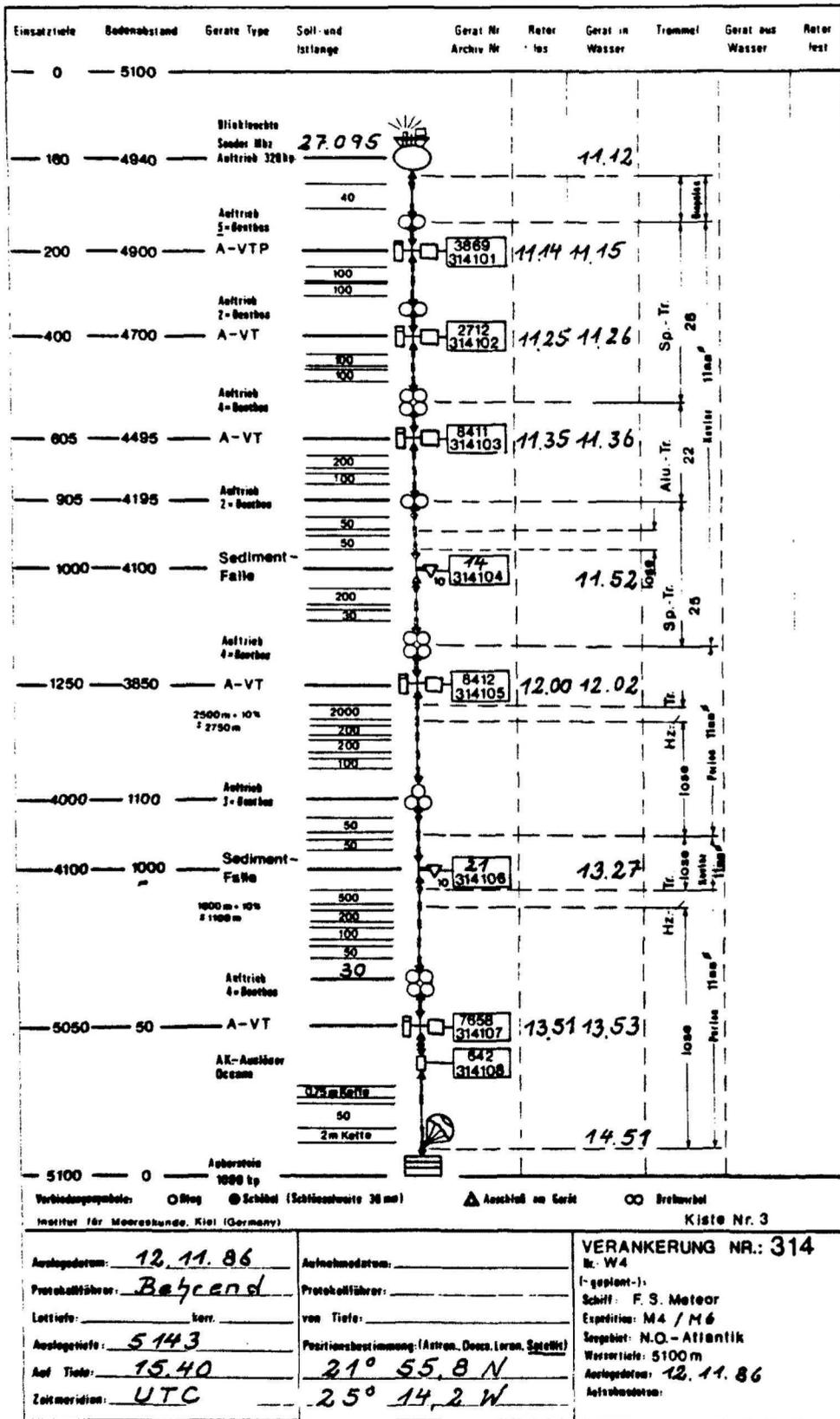
Abb. 3.2: Aufbau der Verankerung Nr. 314, ausgelegt am 12.11.86 mit fünf Strömungsmessern und zwei Sedimentfallen auf Position W4
