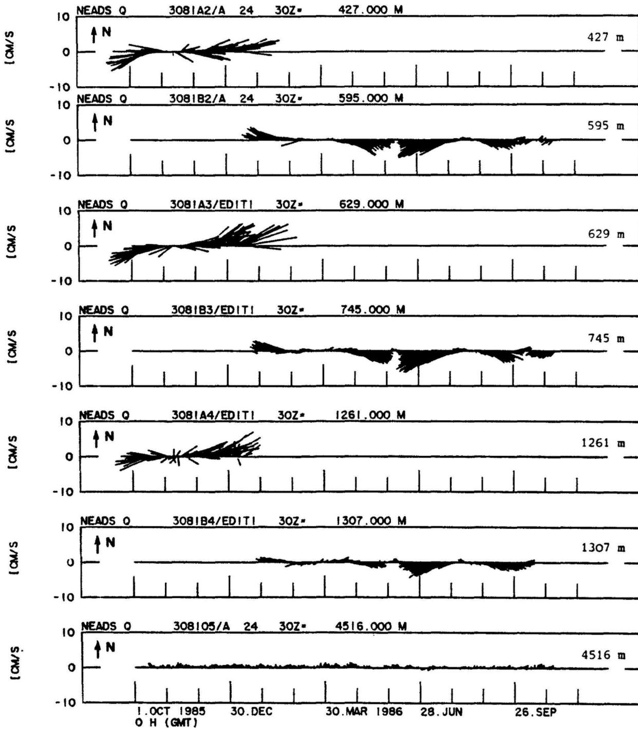
Abb. 3.16a: Verankerung Q/308-1; Zeitreihen des Strömungsvektors in 7 Tiefen. Ab Januar 1986 Verlust des obersten Auftriebselements mit verstärkter Verankerungsbewegung
