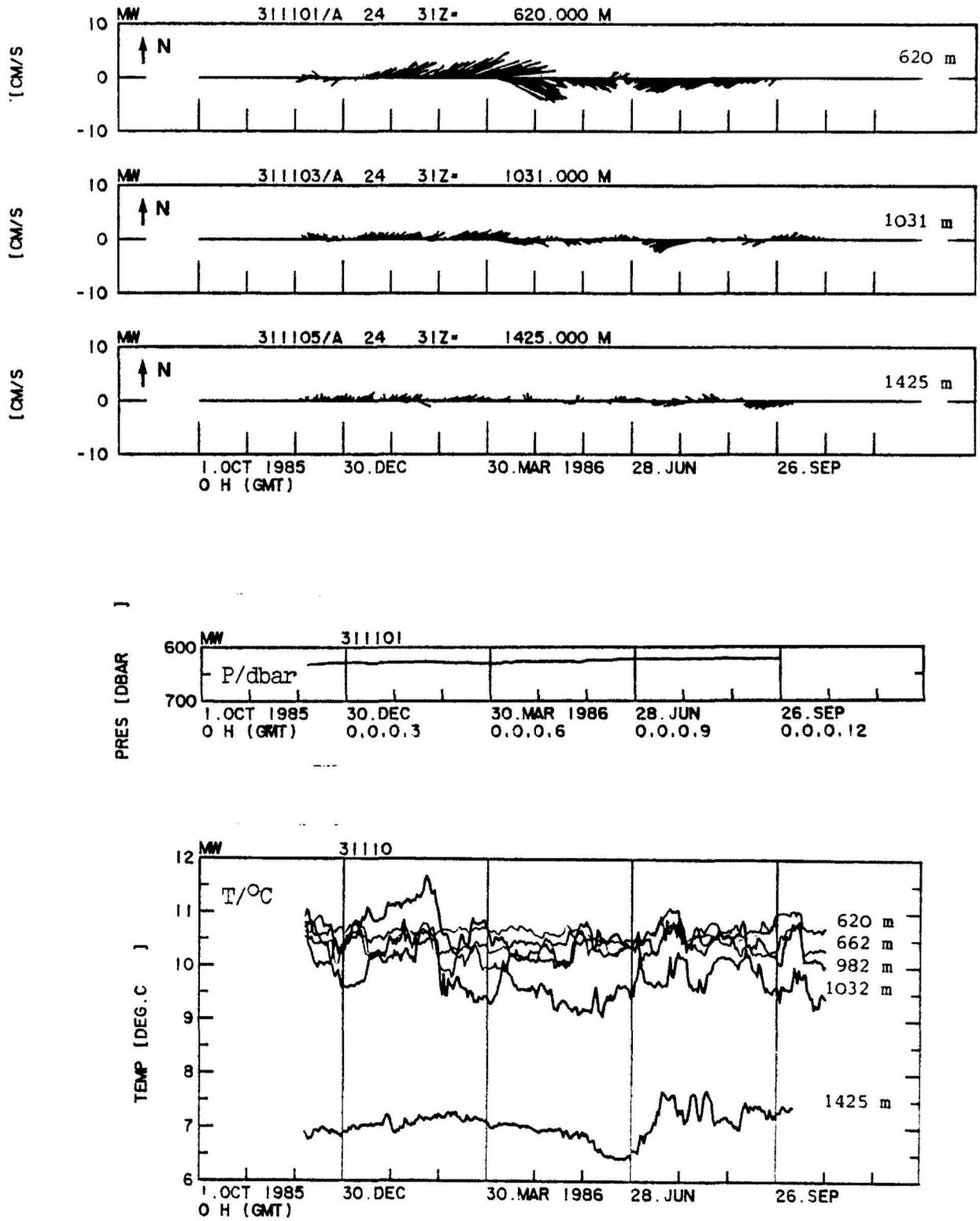
Abb. 3.10: Verankerung MW/311-1; Zeitreihen des Strömungsvektors, des Drucks und der Temperatur im Tiefenbereich des Mittelmeerwassers
