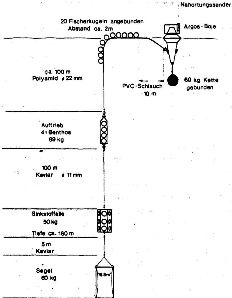
Abb. 3.1: Aufbau des treibenden Meßsystems mit Sinkstoffalle in 160 m Tiefe und ARGOS-Boje mit Nahortungssender an der Oberfläche
