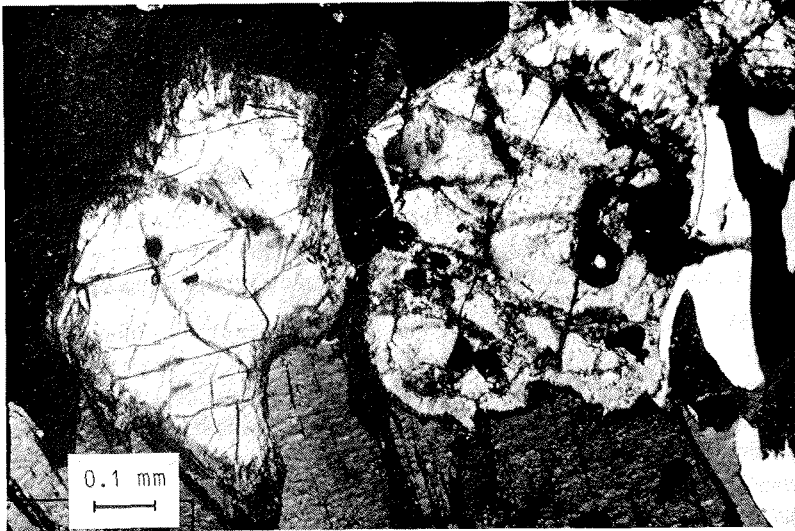
Abb. 2.-11: Um Orthopyroxenkristalle ist im Kontakt zu Biotit ein Reaktionssaum ausgebildet; Augengneis vom Sollienabben (Probe PS 136).
