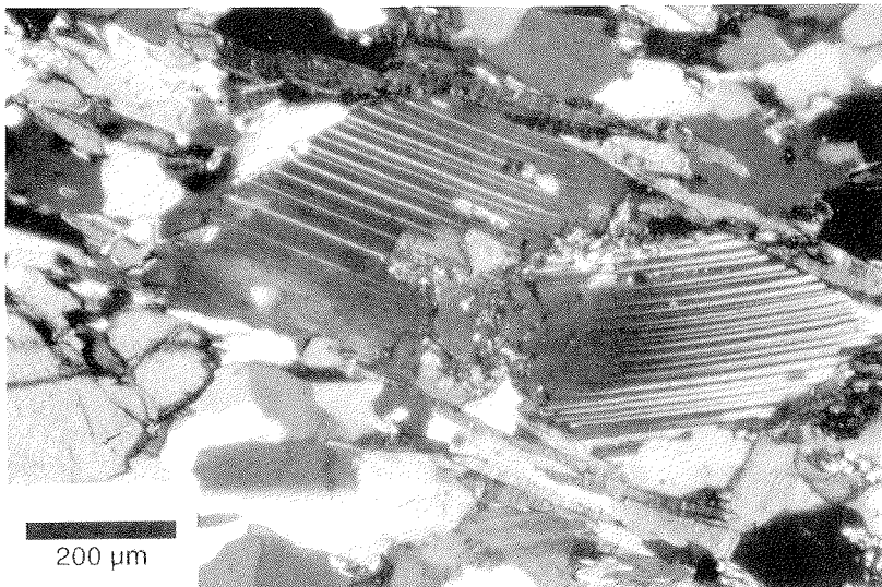
↑ Abb. 3-9: Plagioklas-Deformationszwillinge in einem retrograd überprägten basischen Granulit (Pyroxen-Biotitgneis, Probe AB 284A, Sludanoy Ridge). Für die beiden Druckzwillinge ist das Auskeilen ihrer Zwillingslamellen typisch. Plagioklas-Druckzwillinge gehen oftmals aus Deformationslamellen hervor. XZ-Schnitt. Gekreuzte Nicols.
