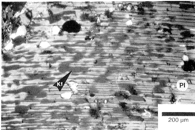
↑ Abb. 4-9: Porphyroblast mit fleckiger Entmischung eines ursprünglich ternären Feldspats im Dünnschliff (Pyroxen-Biotitgneis AB 284, „Sludanoy Ridge“, Herbert Mountains). Die ausgedehnten Entmischungsflecken des Kalifeldspats Or_{92}Ab_{08} (in Dunkelstellung, Pfeil) sind typisch für hochgradig gebildete Feldspäte (KROLL et al. , 1993). Obwohl der teilweise mikroklinisierte Kalifeldspat bereits große Bereiche des Kristalls einnimmt, handelt es sich dem Typ nach um eine antiperthitische Entmischung. Der Ca-reiche Plagioklas-Wirtskristall Ab_{52}An_{47}Or_{01} (PI) ist deformiert und an seinen charakteristischen Deformationszwillingen zu erkennen, an denen sich der entmischte Kalifeldspat orientiert. Mikrosondenprofil siehe Abb. 4-10. Gekreuzte Nicols.
