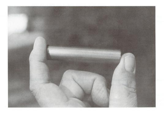
Es handelt sich um einen Einkanal-Logger mit einem Eingangs-Meßbereich von 0...2.5 V, an den beliebige Meßwertgeber mit entsprechendem Ausgang angeschlossen werden können.
