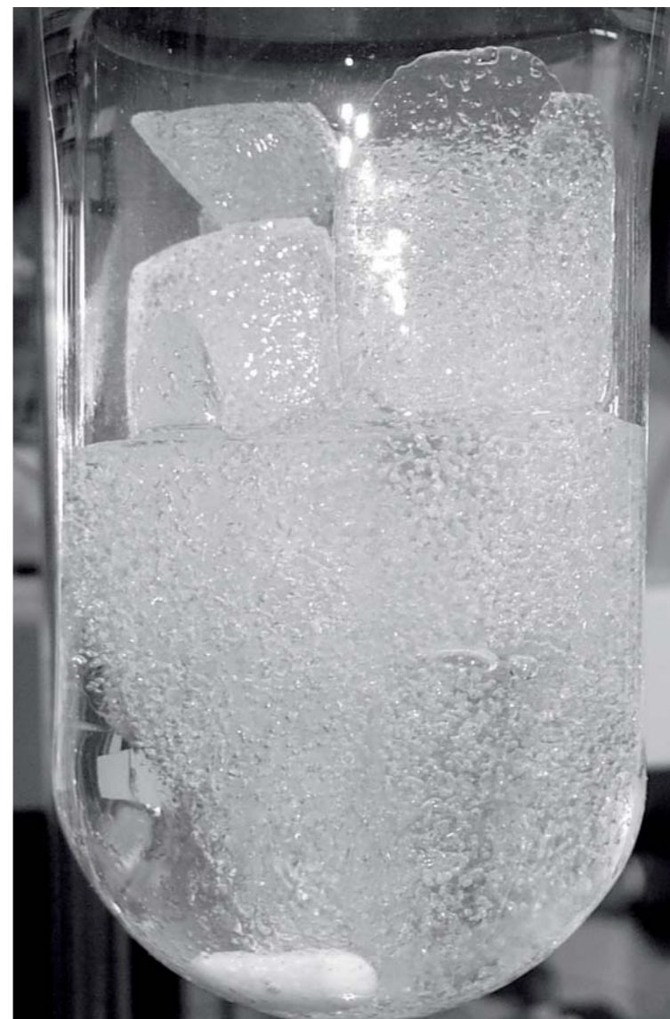
Abb. 14: Schmelzextraktion und Austreiben von Methan aus Eiskernluftblasen für die Isotopenanalyse
