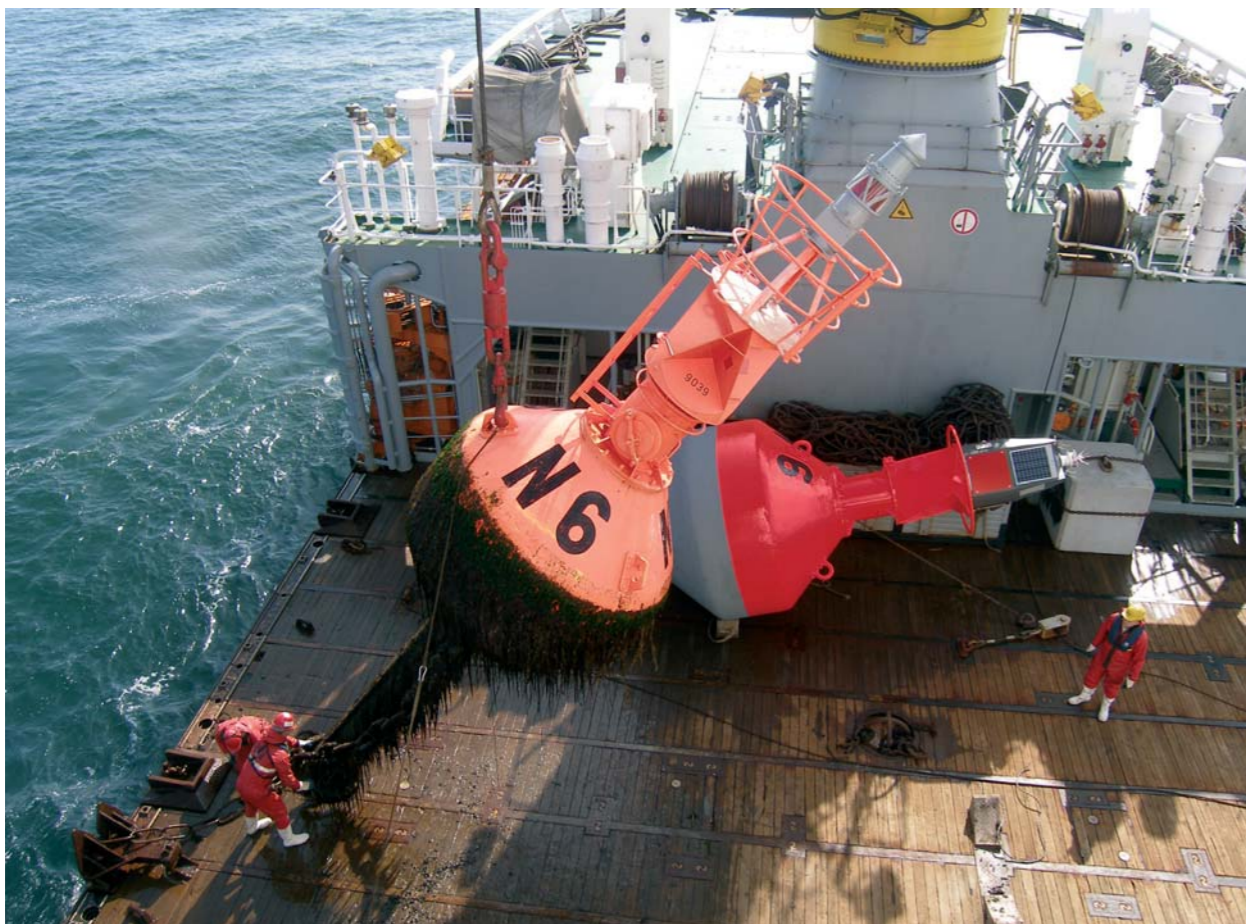
Abb. 2: Austausch einer Navigationsboje durch GS „Neuwerk“ nach einer etwa einjährigen Liegezeit
