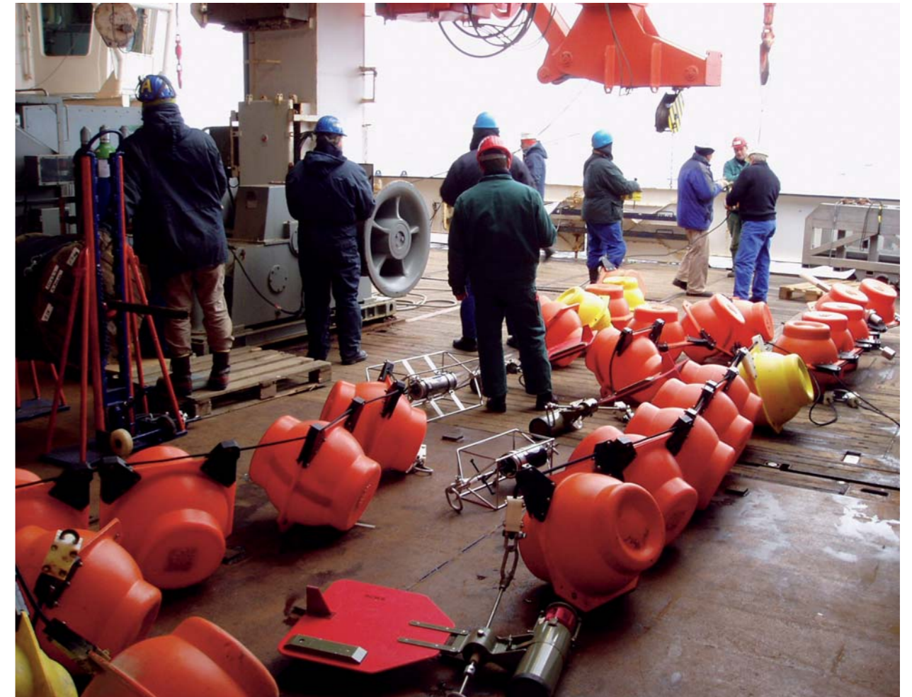
Abb. 3: Vorbereitung einer Strömungsmesserverankerung zur Auslegung in der Framstraße an Bord der ‚Polarstern‘
