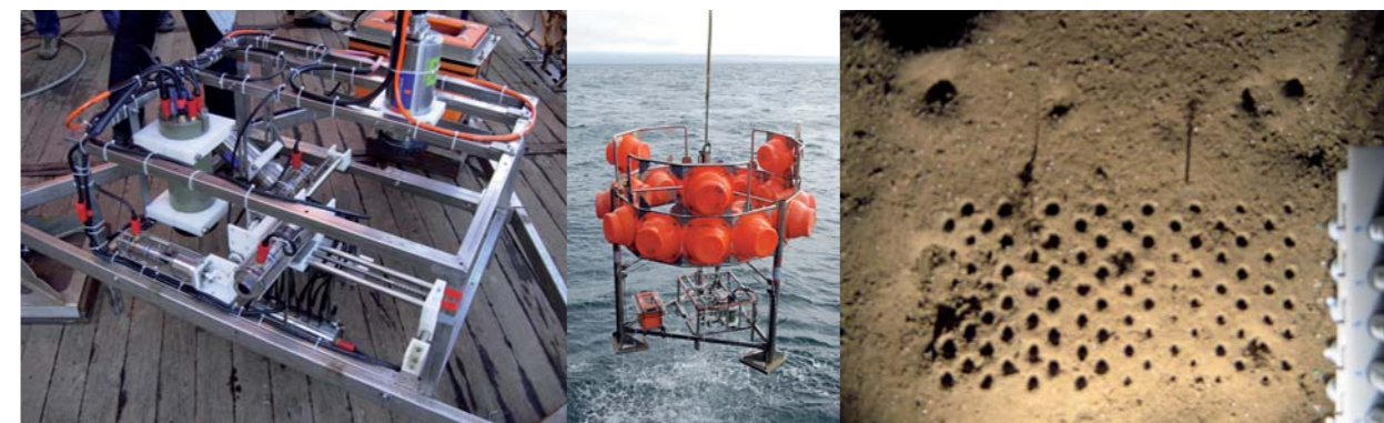
Abb. 12: Der neue 3D-Mikroprofiler (links) vor dem Einsatz mit einem Freifallgerät (Mitte) während der ‚Polarstern‘- Expedition ARK XXII/1 sowie ein Foto des Meeresbodens in 2449 m Wassertiefe im „Hausgarten“ Tiefseeobservatorium nach einem erfolgreichen Messdurchlauf (rechts)
