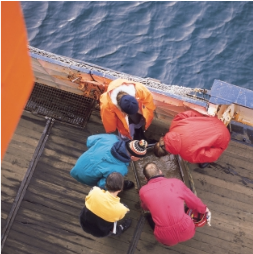
Der Kastengreifer hat ein Stück Sedimentoberfläche an Deck geholt Recovery of sediment surface with a box corer
