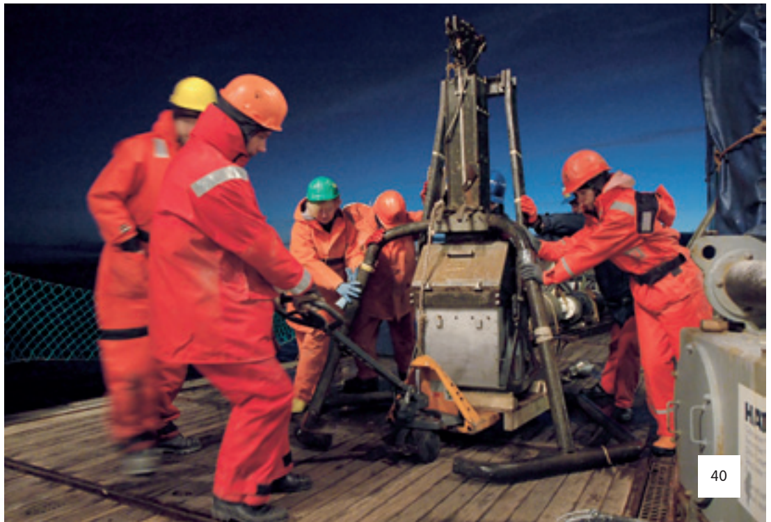
MULTICORER Zur Gewinnung von ungestörten Sedimentproben wird ein so genannter Multicorer (MUC) eingesetzt. Dieses Gerät wird zum Meeresboden abgesenkt. Dort stechen 8 oder 12 Plexiglasrohre bis zu 50 cm lange Sedimentkerne aus dem Meeresboden. Der Einsatz eines MUC in großen Wassertiefen (> 4000 m) kann mehrere Stunden dauern.
