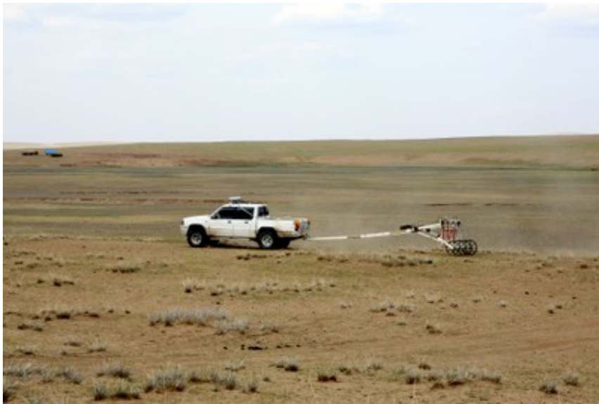
Abb. 9: Das SQUID-System im Einsatz: geomagnetische Messungen.
