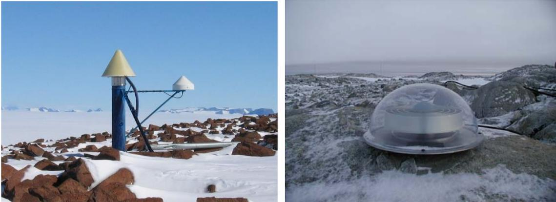
**Bild 6.1: IGS-Antennen-Domes, links: Sanae mit TCWD; rechts: Casey mit AOAD/M\_T (IGS, 2006)**
