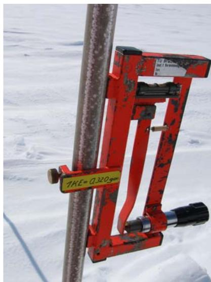
Bild 4.2: Klinometer an einer Balise
