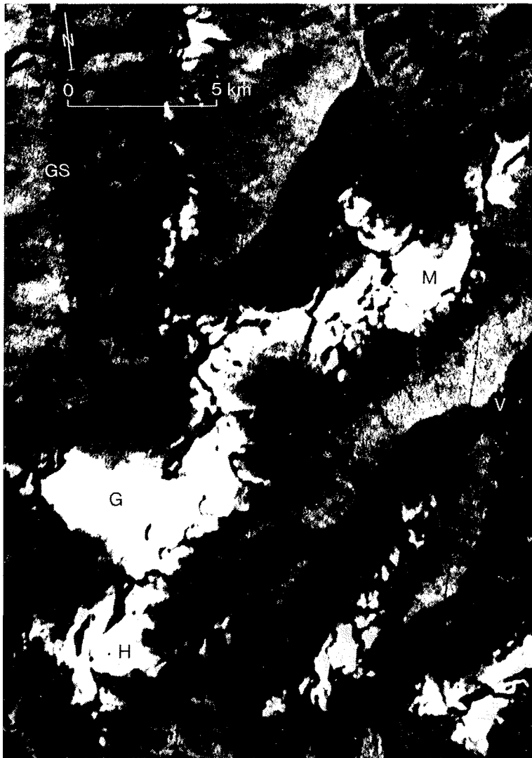
Abb. 2: Bildausschnitt wie Abb. 1, MSS-Kanal 7 ( 0,8-1,1 \mu\text{m} ) mit lithographischem Film kontrastreich ausgearbeitet.
