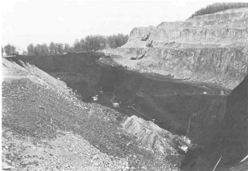
Abb. 3. Tagebau Kalbe (1. 6. 1965). Blick von der Innenkippe in Richtung Stinksteinwand/Lettenberg. Im Zentrum das mächtige Braunkohlenflöz, im Hintergrund rechts, der überlagernde mächtige Deckenbasalt.
