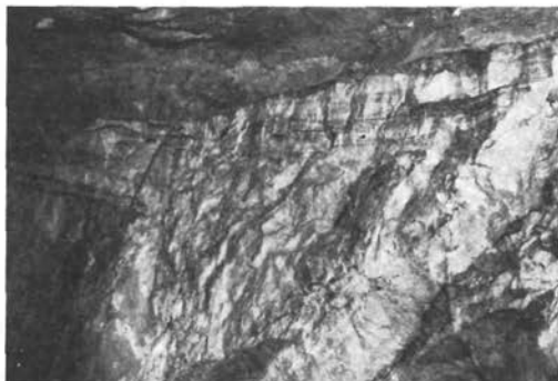
Abb. 8. Der ältere NW–SE-Gang der Grube Gustav wird von einem W–E streichenden, jüngeren Gang abgeschnitten. Während der tektonischen Vorgänge wurde noch jüngerer Baryt gebildet, der auf beiden Gängen auftritt. – Abbau unmittelbar unter der II. Tiefbausohle. Firstenansicht.
