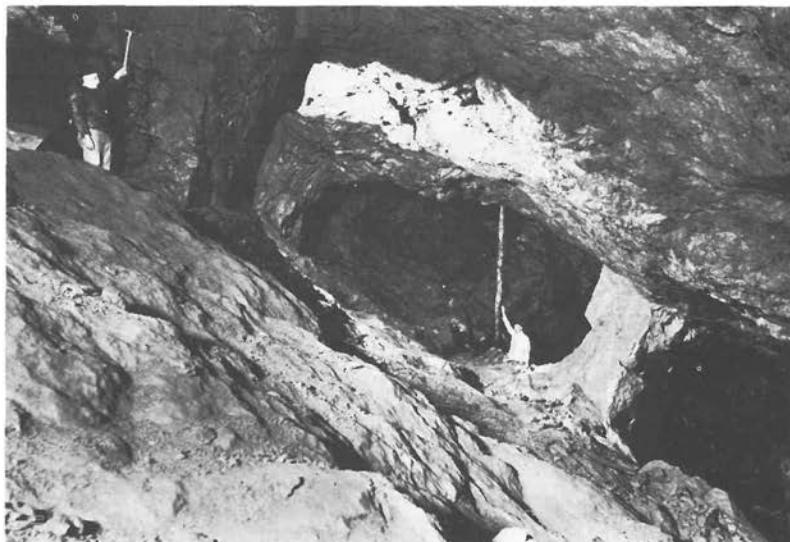
Abb. 5. Roteisensteinabbau (Strossenbau) im Weintrauber Lager nordöstlich von Lerbach. Mächtigkeit des Erzlagere 2–3 m. Im Liegenden und Hangenden Diabas. Die Pfeiler bestehen aus stark kieseligem Roteisenstein mit 25,7% Fe, 52,7% SiO 2 und 3,6% CaO (nach WILKE 1937). Aus JORDAN (1976, S. 99) mit freundlicher Genehmigung des Verlages.
