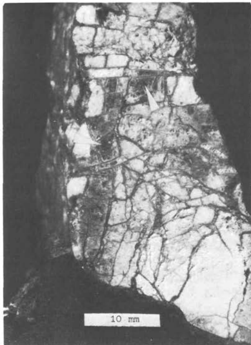
Abb. 5. Querschnitt durch einen ehemaligen Quarzit-Einschluß, der fast vollkommen in Gyrolith, Okenit, Apophyllit und Calcit umgewandelt ist. Grauschwarz mit Pfeil Quarz-Reste. Dunkle Adern besonders Apophyllit-reich. Unten an der Basaltgrenze unveränderter Pyroxenreaktionssaum aus der Pyrometamorphose (Paragenese I).
