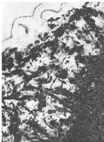
Abb. 2. Dünnschliff, ein Pol. Schnitt durch Gesteinsstück der Abb. 1. Rechts unten normaler Basalt (dunkel), nach links anschließend grobkörniges pegmatoides Gestein. Links oben Zeolith-Auskleidung der Blase, zu unterst Gonnardit, darüber Thomsonit; vgl. auch Abb. 4. Lange Bildkante 1 cm.
