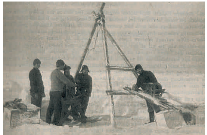
Abb 17: Lotung der Meerestiefe und Entnahme von Wasserproben mit einer kleinen Lucas-Maschine weit vom Schiff entfernt auf dem Meereis (BRENNKECKE 1921 S. 31).
