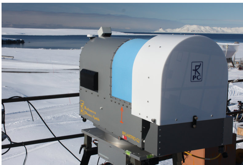
Abbildung 2.24: Radiometer auf dem Dach der AWIPEV-Station
