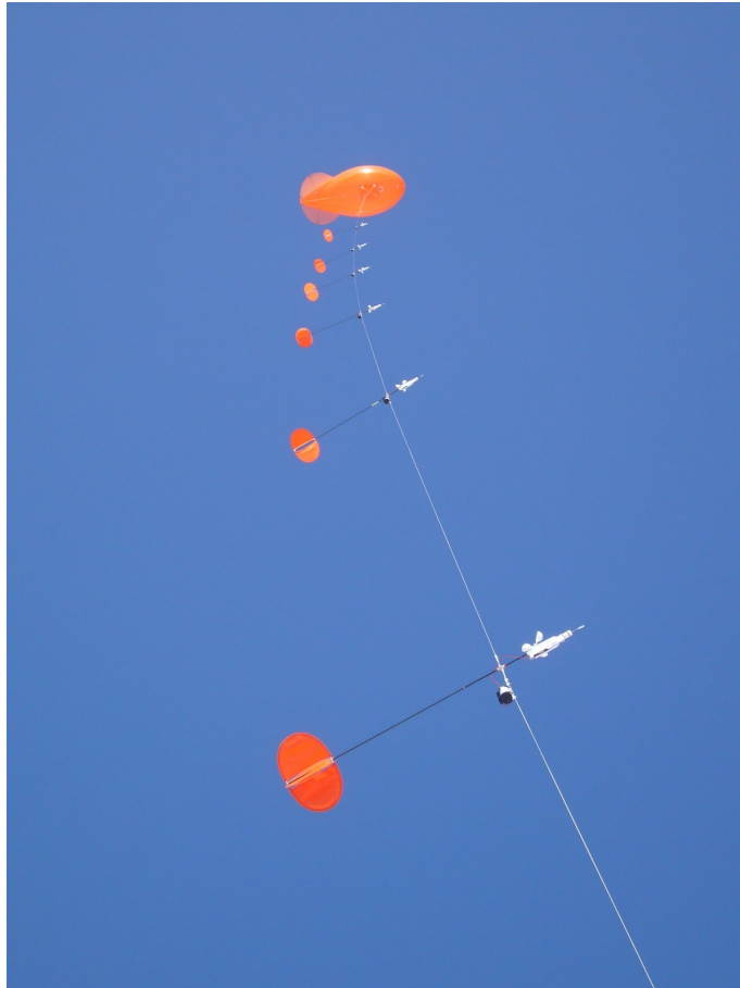
Abbildung 2.14: Fesselballon mit sechs Sonden
