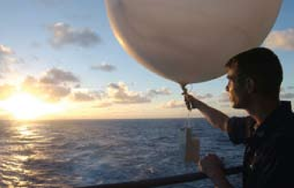
Abb. 4: Zur Ermittlung der Höhenwetterdaten lässt man weltweit an mehr als tausend Orten mindestens zweimal täglich, um 12:00 und 24:00 Uhr, Wetterballons mit Radiosonden aufsteigen.
