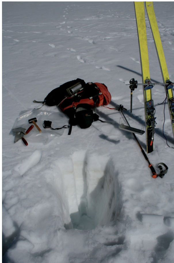
Abbildung 7: Schneeschacht am Kesselwandferner am 05.09.2012. Die mittlere Dichte im Schacht beträgt 533 \text{ kg/m}^3
