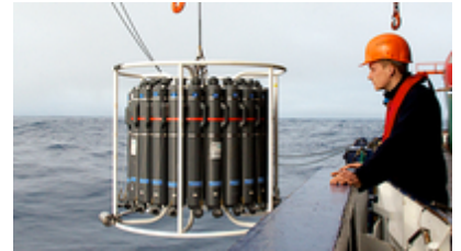
Aussetzen des Kranzwasserschöpfers (CTD), mit dem vertikale Profile von Temperatur und Salzgehalt bis zum Meeresboden gemessen und Wasserproben in verschiedenen Tiefen genommen werden.
