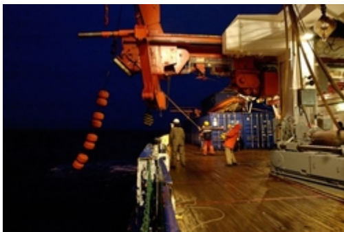
Nächtliche Bergung der M4-Verankerung
