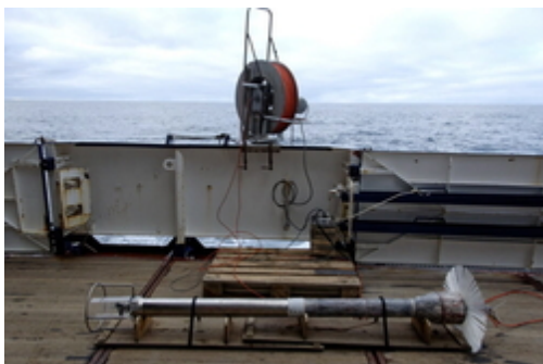
Das profilierende Mikrostrukturmessgerät mit der dazu gehörenden Winde
