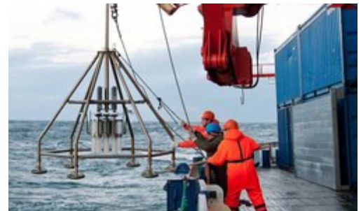
Sedimentkernbohrer vor dem Einsatz (© M. Damerau)
