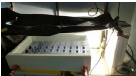
Abb. 6: Inkubator zur Messung von Lichtkurven der Algenproduktion, konstruiert von Patrick Meyer (MPI) (© M. Fernandez)
