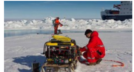
Abb. 4: Das ROV wird für einen Taucheinsatz während einer Eisstation vorbereitet. Im Hintergrund wird die Albedo des Eises und eines Schmelztümpels vermessen. (© M. Nicolaus)
