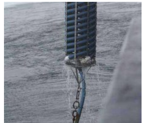
Abb. 7: Bergung eines besonderen Gerätes an unseren Verankerungen: ein Instrument genannt "Henne", das ein neues Konzept für Messprofile an Verankerungen ohne Energieverbrauch umsetzt. (© B. Rabe)
