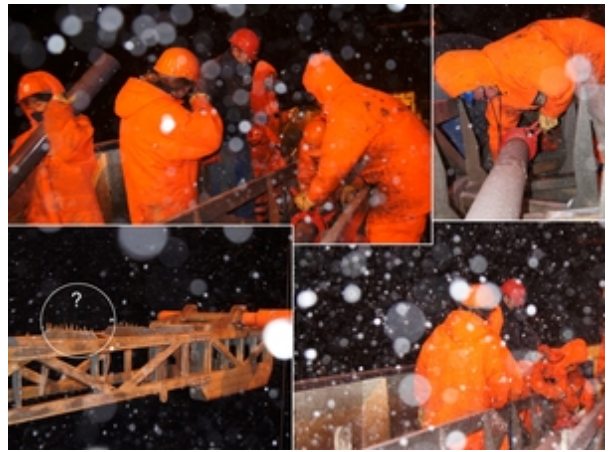
Abb. 4: Das Geologen-Team in Aktion auf dem Achterdeck. Eines der letzten Schwerelote liegt im Kernabsatzgestell vor uns und wird unter winterlichen (weihnachtlichen?) Bedingungen „verarbeitet“, d.h., es wird das Plastikrohr („Liner“) mit dem Sediment aus dem Metallrohr gezogen und in handliche Meterstücke zerschnitten, die dann ins Nasslabor transportiert werden. Hier vor Ort in der Arktis herrschen schon komische Bedingungen, da scheinen ja sogar die Eiszapfen entgegen der Schwerkraft in den Himmel zu wachsen (siehe „?“). Oder hat jemand eine bessere/sinnvollere Erklärung für dieses Phänomen? (Einzelfotos von H. Jin/SIOSOA).
