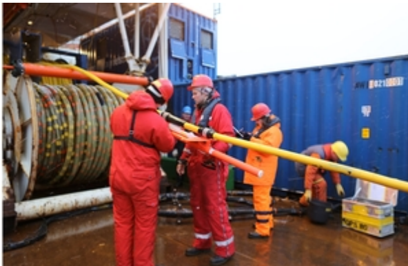
Abb. 1: Geophysiker in Aktion auf dem Achterdeck. Anbau eines Tiefenreglers an unser Messkabel (gelb). Dieser Tiefenregler kann aus dem seismischen Messraum über das Kabel ferngesteuert werden. (Foto: A. Bublitz/UoT).
