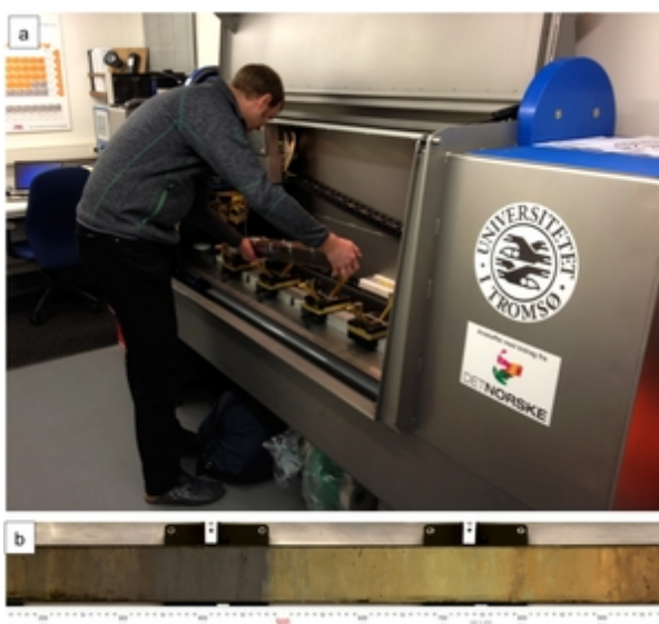
Abb. 3: (a) Matthias Forwick in seinem XRF-Scanner-Container (Foto: R. Stein/AWI). (b) Ergebnis eines XRF-Farbescans von einem ausgewählten Sedimentkern (Foto: M. Forwick/UoT).
