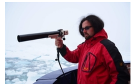
Abb. 4: Unser Ozeanograph Albrecht Roloff (der eigentlich Geologie-Student ist!!) hat seine XCTD „abgeschossen“ und zeichnet jetzt über den abrollenden Kupferdraht (der bei genauem Hinsehen noch zu erkennen ist) die ozeanographischen Daten auf (Foto M. Winkler/AWI)
