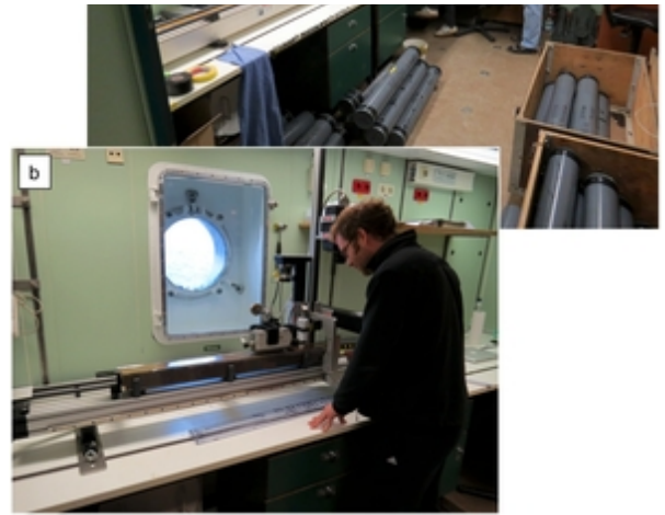
Abb. 2: Logging an Bord Polarstern (Fotos: R. Spielhagen/GEOMAR). (a) Labor 1 mit MSCL-Messbank und Schwerelotkernen, die durch den Logger laufen. Im Hintergrund Oberlogger Frank Niessen und Logging-Assistentin Tanja Hörner. (b) Labor 2 mit Farbscanner und Punkt-Suszi-Sonde. Am Gerät Michael Schreck.
