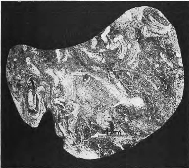
Bild 11. Aus dem Schlick-Watt. Wühlgefüge im Schlick wird wie hier meist erst im durchscheinenden Schliff sichtbar. Senkrechter Schliff einer Probe vom Prielhang, daher schräg verlaufende Schichtung von links oben nach rechts unten. — Marien-Tief; 1. 2. 1956. Bildarchiv L 7164, S. a. M. Schliff Nr. 36.
