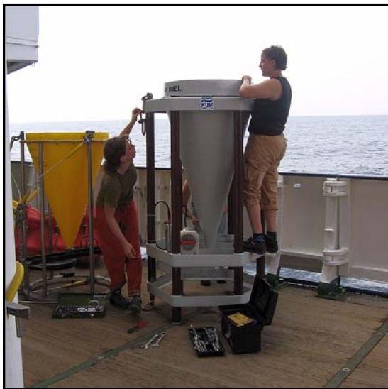
Die Sinkstofffallen werden an Deck für den Einsatz vorbereitet und danach im Arabischen Meer ausgesetzt. Photos: M. Bayer
