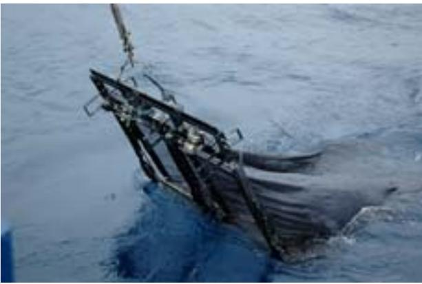
Das 1m<sup>2</sup>-Doppel-MOCNESS beim Einholen. Die letzten beiden Netze bleiben zur Stabilisierung geöffnet.
