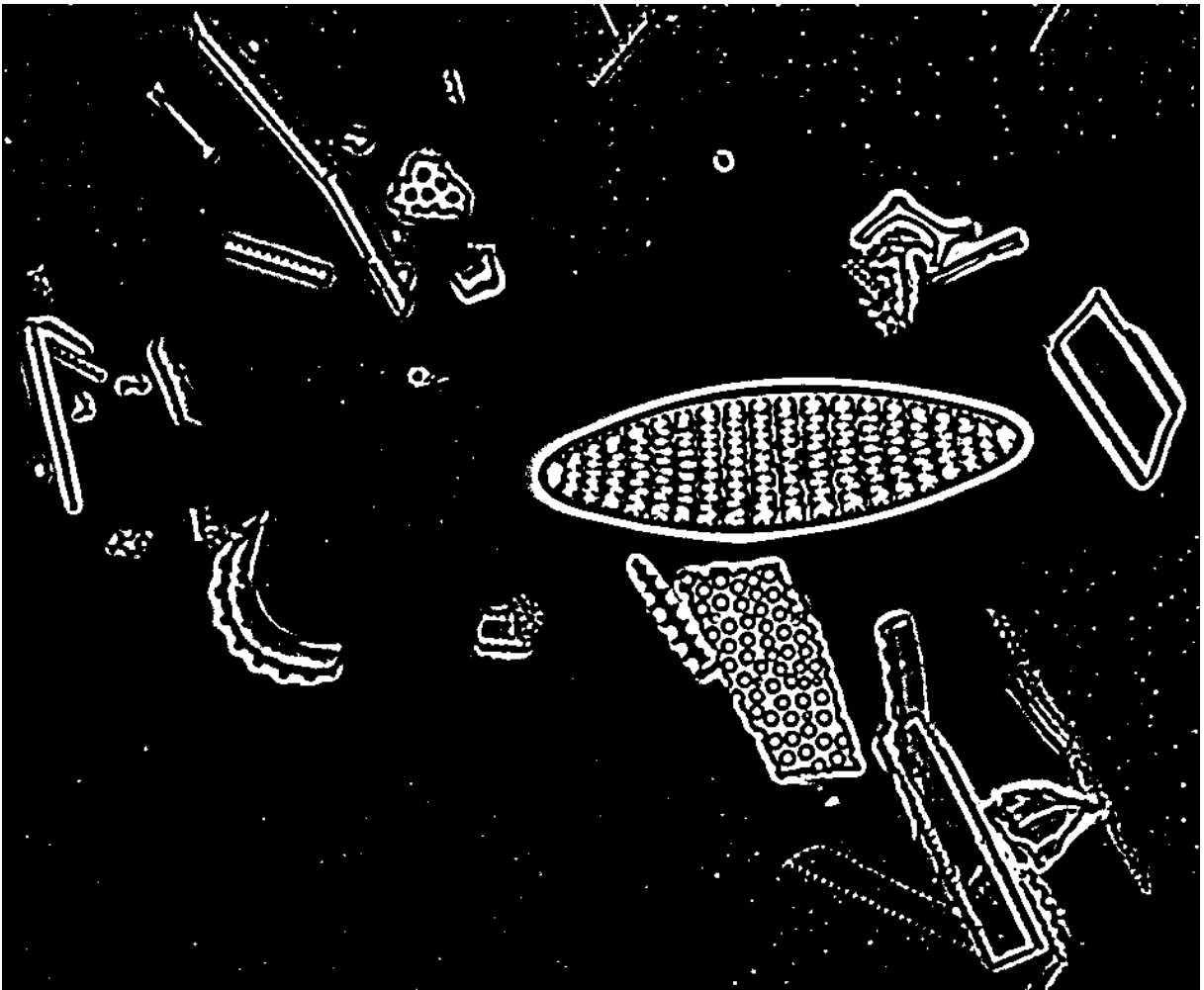
Abbildung 22: Daten aus Abbildung 15, gefiltert mit einem Gauß-Kern von 7 Pixeln Durchmesser und segmentiert mit Adaptive Thresholding (Durchmesser der lokalen Nachbarschaft 13 Pixel). Statt des tatsächlichen Objektrandes wird ein ihn umgebender Saum segmentiert, was zu verfälschten Ergebnissen führt.
