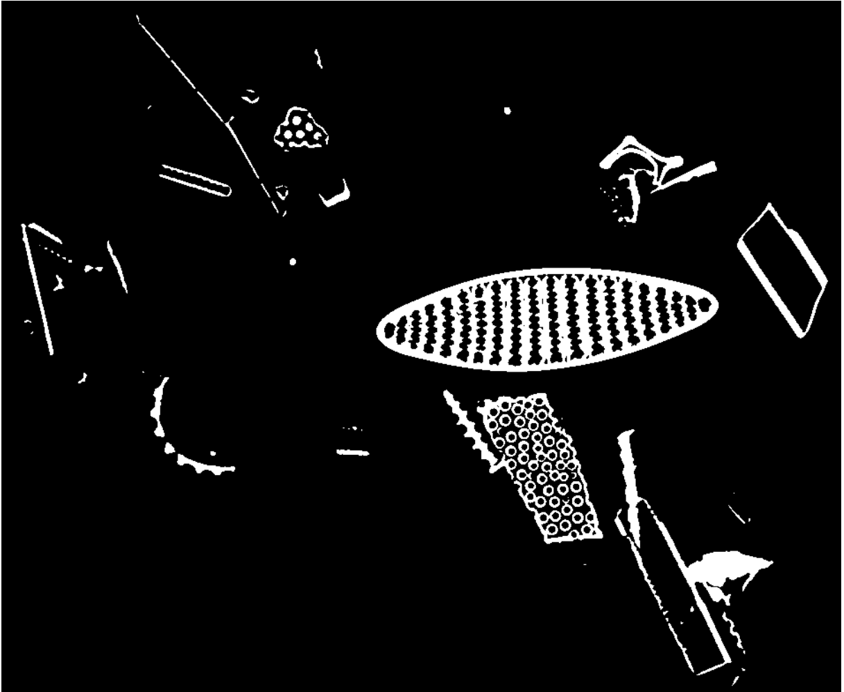
Abbildung 20: Daten aus Abbildung 15, gefiltert mit einem Gauß-Kern von 5 Pixeln Durchmesser und segmentiert mittels RATS ( \sigma = 3,0 ; Exponent = 2,0). Die äußeren Konturlinien entsprechen für die Valve dem tatsächlichen Objektrand.
