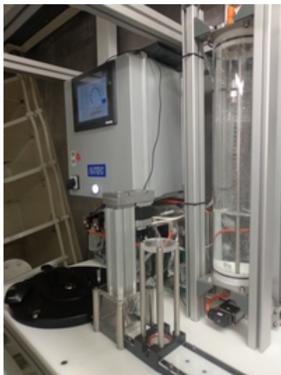
Abb. 4: Foto der "Automatic Filtration of marine Microbes (AUTOFIM)-Einheit". In dem Gerät können bis zu 24 Filter automatisch bearbeitet werden. Pro Filter können bis zu 5 Liter Meerwasser für die Probennahme kleiner mariner Organismen genommen werden. Foto: Johanna Hessel
