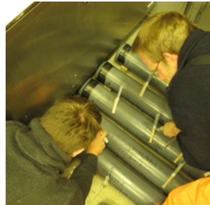
Abbildung 10: Michael Nairn und Christian März bringen Rhizone zur Porenwasserbeprobung an einen Schwerelotkern an (Foto: Eunmi Park).
