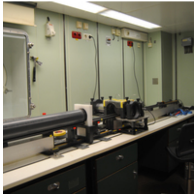
Abbildung 9: Mit Hilfe des Multisensor Core Loggers werden physikalische Eigenschaften des Sediments gemessen (Foto: Kirstin Werner).
