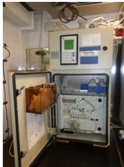
Abb. 5: Das Nährstoffmessgerät \mu MAC-C ist in das Oberflächenmesssystem der Ferrybox integriert und misst kolorimetrisch die folgenden Nährstoffe, Phosphate, Silikat, und Nitrate/Nitrite. Foto: Johanna Hessel
