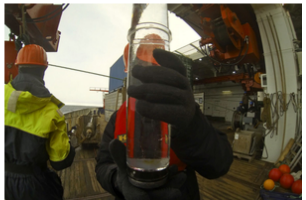
Abb. 5: Blick auf eine Sedimentfalle, die in 90 m Wassertiefe verankert war. Auf dem Boden des Gefäßes sind die herabgesunkenen Partikel zu erkennen (Foto: Christine Dybwad).
