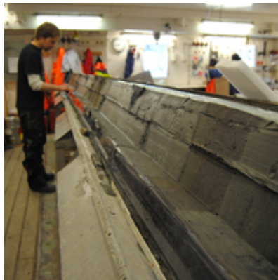
Abbildung 6: Das geöffnete Kastenlot nach der ersten Probennahme (Foto: Kirstin Werner)
