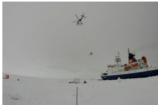
Abb. 2 EM-Bird wird über die Eisstation geflogen, um die Eisdicken zu messen (Foto: Bennet Juhs).
