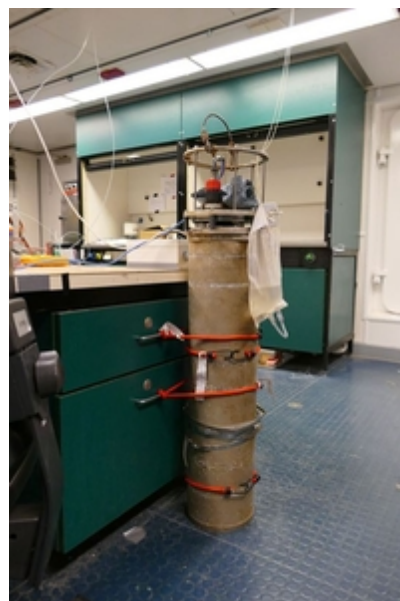
Abb. 3: Der "Imaging Flow Cytobot (IFCB)" kann kontinuierlich die Zellzahlen und die Biomasse von Phytoplankton aus
