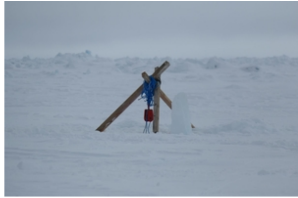
Abb. 3: Ein improvisierter Tripod mit Block für eine kleine Verankerung im Eis, mit der herabsinkende Partikel beprobt werden. Foto: Ilka Peeken
