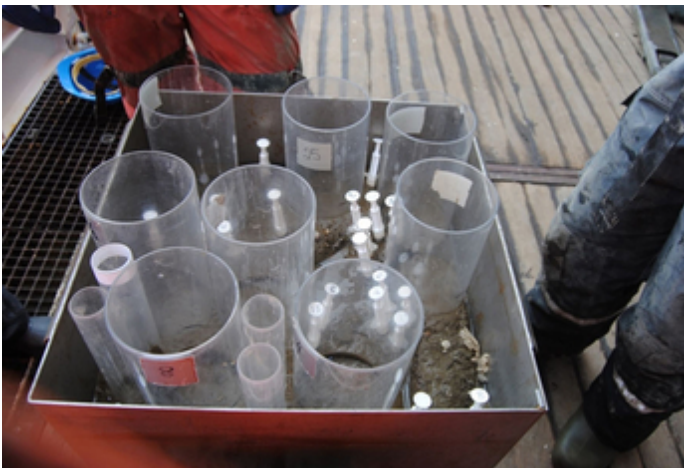
Abb. 7: Beprobung des Kastengreifens mit verschiedenen Rohren und Spritzen (Foto: Kirstin Werner).
