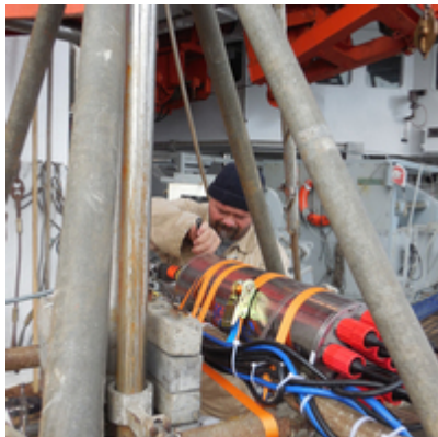
Abbildung 5: Der Windenelektroniker Thomas Feiertag installiert das Kamerasystem am Multicorer für hochaufgelöste Aufnahmen aus der Tiefsee (Foto: Jens Matthießen).
