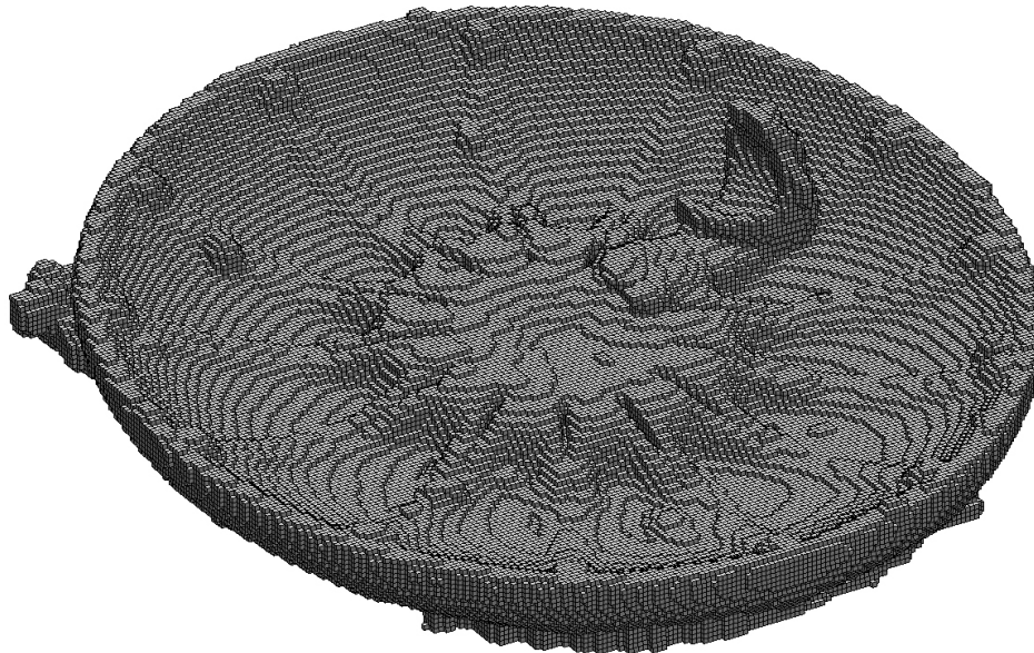
Abb. 6.15: Darstellung des Bauraumes (DSS+) auf Basis von Asterolampra sp. , welcher mit Hexaederelementen vernetzt wurde.
