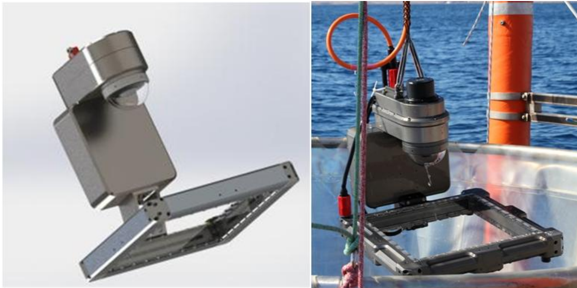
Abbildung 7: Zeichnung (Develogic, 2013) und Foto (T. Boxhammer, 2014) des KielVision Systems bei einer Langzeitmesokosmen Studie auf den Kanaren.
