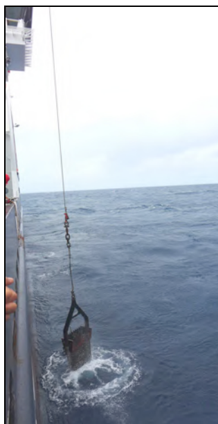
Eine Kettensackdredge wird mit Gesteinen aus 4.600 m Wassertiefe an Bord der SONNE gehievt. (Foto: Luise Wagner)
