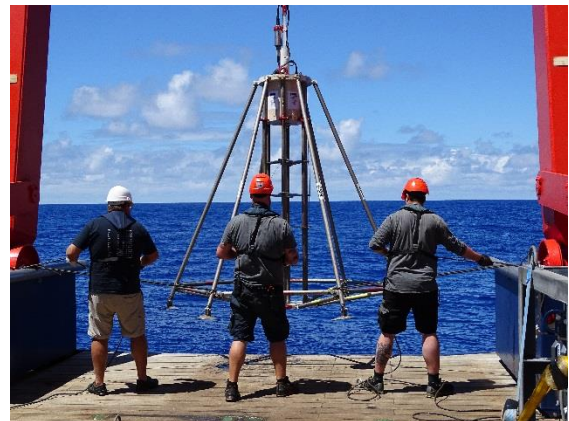
Ausbringen der BGR-Wärmestromsonde.
