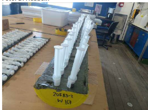
Sedimentkernbeprobung mit zwei Spritzenserien. Foto: D. Hebbeln
