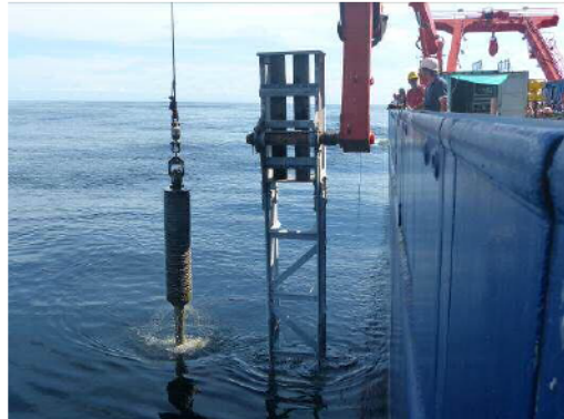
Das 12 m Schwerelot kommt wieder an Bord. Foto: D. Hebbeln
