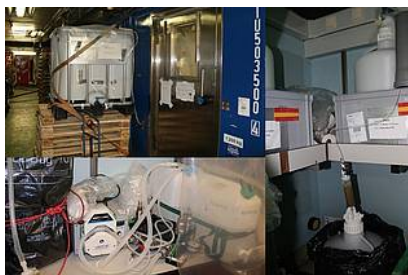
Abb. 5: Seewassertank und Ultrafiltrationseinheit (Foto: Christel Hassler, Universität Genf)
