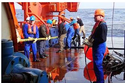
Abb. 5: Mannschaft und Wissenschaft beim gemeinsamen Ausbringen des Seismik Streamers bei dem ersten Geophysik
