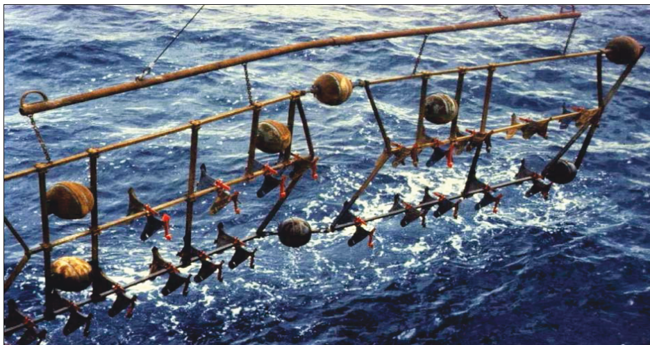
Abb. 3 Tiefsee-Pflug oder Pflugegge, womit 1989 die mechanischen Störungen am Meeresboden erzeugt wurden. Dabei sind keine Mn-Knollen vom Meeresboden entfernt, sondern lediglich untergepflügt worden.
