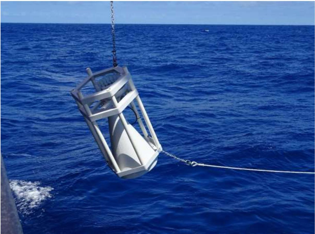
*Ausbringen einer Sedimentfalle zur Bestimmung der bodennahen Sinkstoffe
